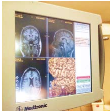
Afb. 4: Het neuronavigatietoestel kan gekoppeld worden aan de O-arm en toont zo tijdens hersenchirurgie op elk moment de exacte positie van een instrument.
